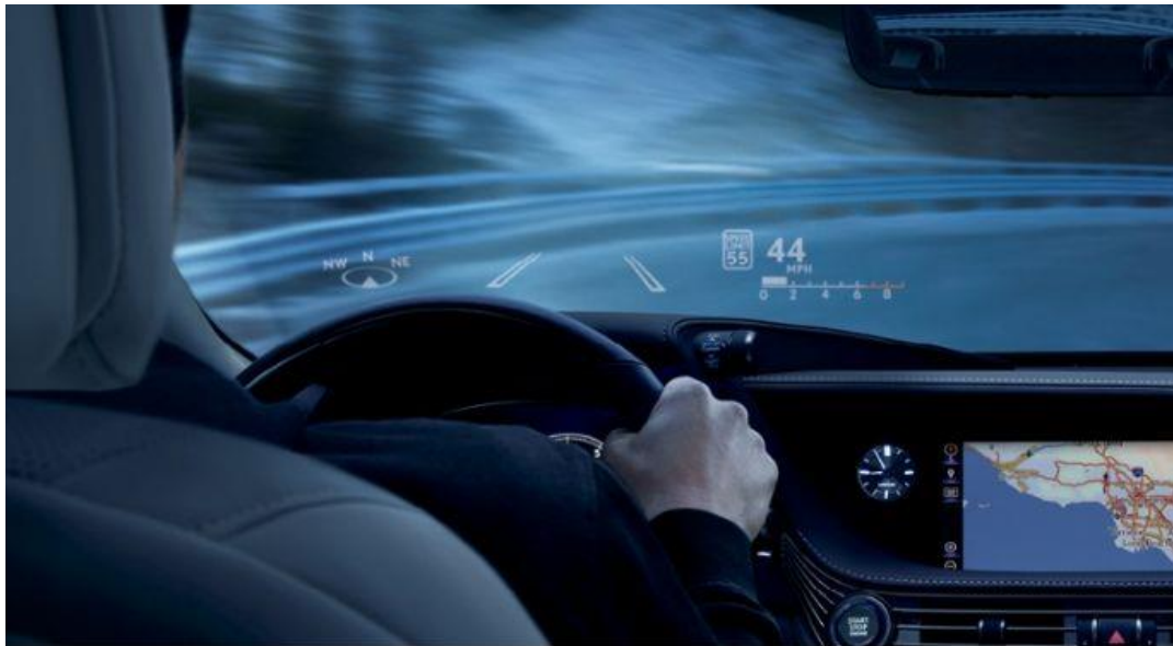
Foto 1: Ejemplo de realidad aumentada aplicado a Head Up Display
